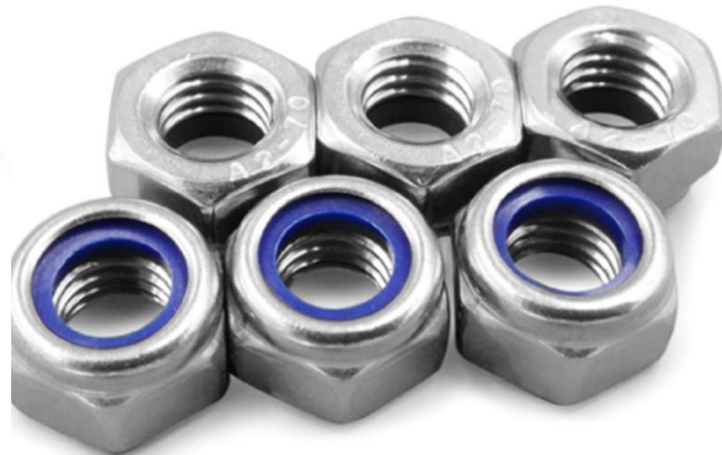
Эти контргайки обладают хорошей химической стойкостью и могут быть слабомагнитными. Нейлоновая вставка удерживает болт при ослаблении, не повреждая резьбу. Их можно использовать повторно, но с каждым использованием их прочность уменьшается.
