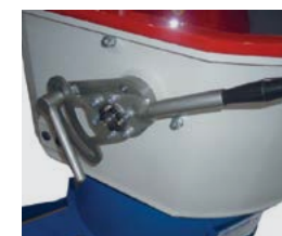
Ручное / автоматическое управление заслонкой сепаратора
