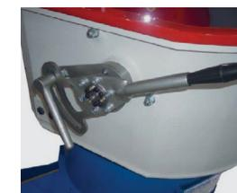
Ручное / автоматическое управление заслонкой сепаратора
